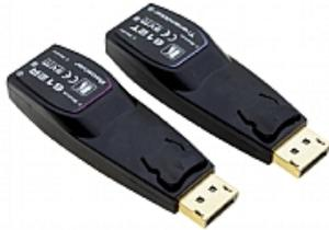
612R/T ist ein kompakter Glasfaser-Sender und -Empfänger, der unkomprimiertes DisplayPort 1.2 über Glasfaserkabel erweitern kann. Dieser Extender-Satz unterstützt die 4K@60 (4:4:4) Auflösung mit bis zu 328 Fuß (100 Meter) auf einem Dual-LC-Multimode-Glasfaserkabel
