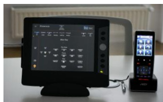
AVIT Control Steuerungslösung: Eingebundene RTI Touchfernbedienung, Licht und Klima über KNX, Videosprechanlage, Konferenzraumtechnik, Multimedia, Home Cinema
