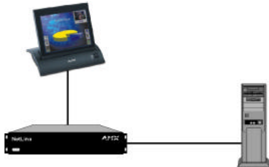
Situation 1: NetLinx wird mit einem einzelnen PC verbunden
